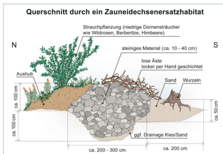
Prinzipskizze eines Ersatzhabitats Quelle: Arbeitshilfe Zauneidechse, LFU 2020
